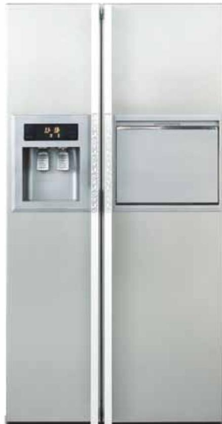
新飞天尊 BCD-558WS 冰箱上冷藏、下冷冻，采用全风冷设计，冷冻、冷凝风机均采用直流电机，噪声小，更节能（功率是普通交流风机的 1/5）。冰箱多功能对开门冷藏室采用中央 LED 照明光源、整体注塑玻璃搁架、透明带滑道抽屉式果菜盒、蛋盒和给水盒；冷冻室采用双层双门滑轨式抽屉结构，德国进口滑轨，上层抽屉设置一套自动制冰机，下层抽屉为大容量食品筐，适合冷冻贮藏多种食品。冰箱使用环保型 R600a 无氟制冷剂，电脑控制式全风冷无霜制冷系统。冰箱还应用了新飞独创的动态立体抗菌技术，综合了紫外线抗菌、臭氧抗菌、钛光抗菌、负离子抗菌等多项抗菌科技，并特别通过动态抗菌离子的作用，更有效的去除冰箱中空气以及视频表面的细菌。
